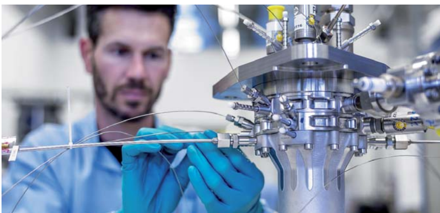
BERTA-Versuchstriebwerk bei der Integration, Foto: ArianeGroup Holding/Alpensektor.
