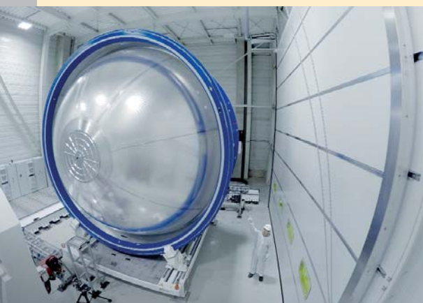
Ariane 6-Oberstufentank in der LST-Kammer. Fotos ArianeGroup
