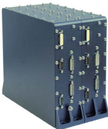
Massenspeichereinheit für die Datenerfassung und Datenspeicherung.
