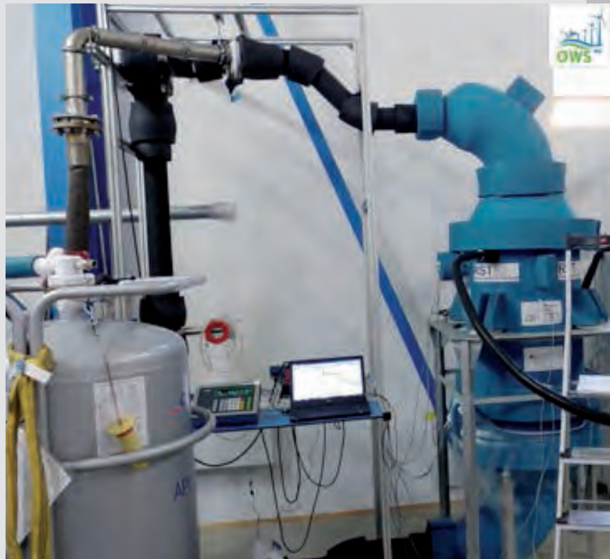
Offshore-Windenergie in Mecklenburg-Vorpommern: Dazu entwickelt RST Rostock System-Technik mit Partnern einen Teststand für den Cryo-Temperatur-Kältespeicher. Fotos: OWS-MV
