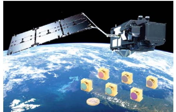
Sentinel-3: SWIR-VLWIR Detektoren zur Klima- und Erdbeobachtung. Foto Satellit: ESA/ATG medialb. Inlay: AIM
